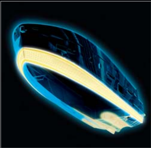
双模式半滑水艇船体，侧推器管道、艉鳍和直立型艏（麦哲伦系列） Dual Mode semi-planing hull with tunnel, skeg and vertical bow (Magellano Collection)
