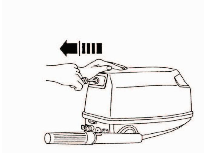
10. Проверьте, вытекает ли стабильная струя воды из индикаторного отверстия водяного насоса.
