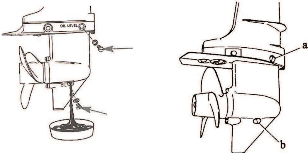
a - Заглушка вентиляционного отверстия
