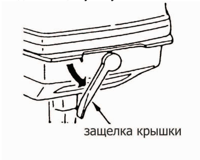
2. Поднимите заднюю часть кожуха и подтолкните ее к передней части двигателя, чтобы очистить передний крюк.
