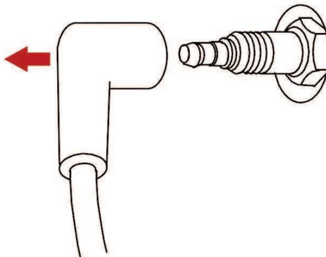
2. Снять и проверить свечу зажигания. Заменить свечу при износе электрода или шероховатости, трещине, поломке или загрязненности изолятора.
