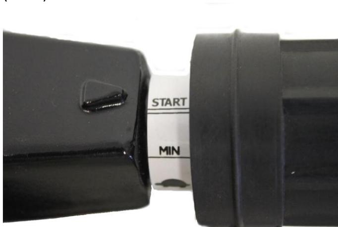
5) Полностью вытащите ручку воздушной заслонки карбюратора.
