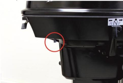
Если при работающем двигателе вода не вытекает постоянным напором из контрольного отверстия, прекратите эксплуатацию мотора. В противном случае он перегреется, и ему будет нанесён серьёзный ущерб. Остановите двигатель и проверьте, не забились ли входное отверстие в корпусе редуктора. Если Вы сами не способны определить и ликвидировать поломку, обратитесь к дилеру ZONGSHEN.
